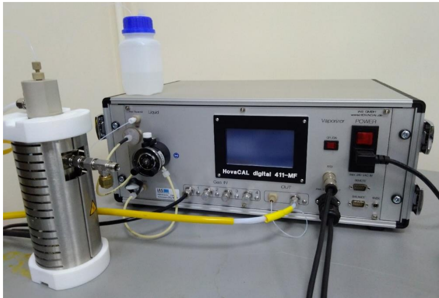
Рис. 3. Генератор увлажненных высокотемпературных газовых смесей
